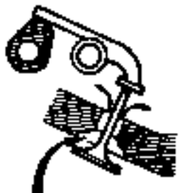
Soupage d'échappement à mettre en pleine ouverture
