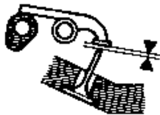
Soupage d'admission à régler
